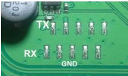
Le port série est situé entre le processeur et les ports RJ45 LAN. La vitesse de connexion est **9600 8N1** (à vérifier en fonction du décodeur)
